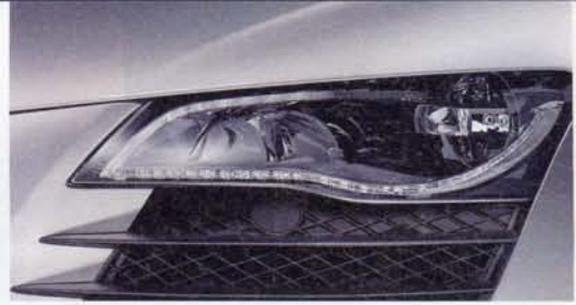
図1 ドイツAudi社の「R8」LED(発光ダイオード)のポジションランプを配したヘッドランプをOptis社のソフト「SPEOS」で設計。
