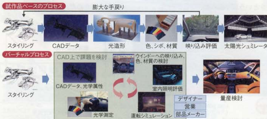
図2 内装設計における開発プロセスの比較
